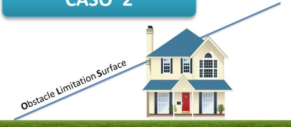
Superficie de protección de la instalación de Navegación Aérea
