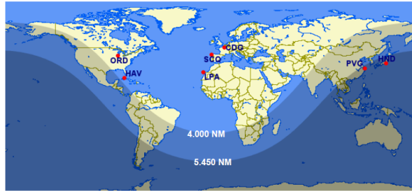
Ilustración 2. Alcances del B-747-400 en SQ para MPL y para número máximo de pasajeros por la pista 17
