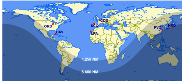
Ilustración 3. Alcances del B-747-400 en SQ para MPL y para número máximo de pasajeros por la pista 35
